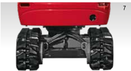
BREEDTE INGESCHOVEN ONDERWAGEN 980 MM
